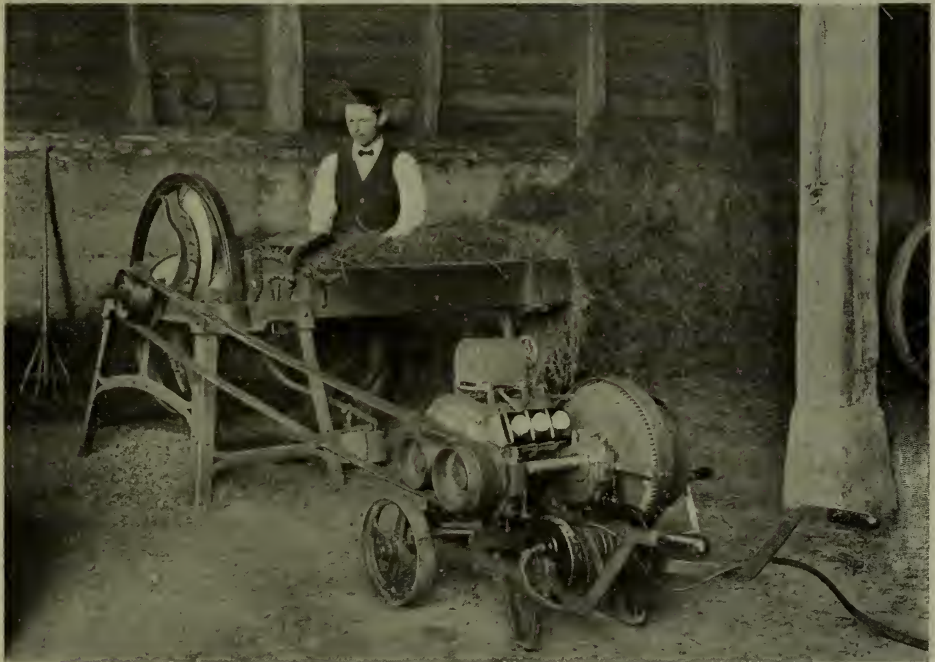
Fig. 175. — Commande d'un hache-paille par un moteur électrique transportable.
